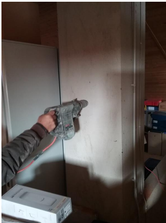
Determinazione della composizione dei pilastri in laterizio a sostegno delle travi di copertura edificio in Cemento Armato, manica Est
