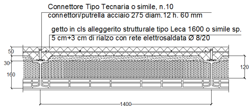
Consolidamento dei solai di copertura in putrelle e tavelle e connettori metallici puntone solaio.
